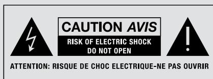
**CUIDADO:** Para evitar o risco de choque elétrico, não remova a tampa (ou placa traseira). Não existem peças reparáveis pelo utilizador no interior. Qualquer serviço de reparação ou manutenção deverá ser executado por pessoal qualificado.
